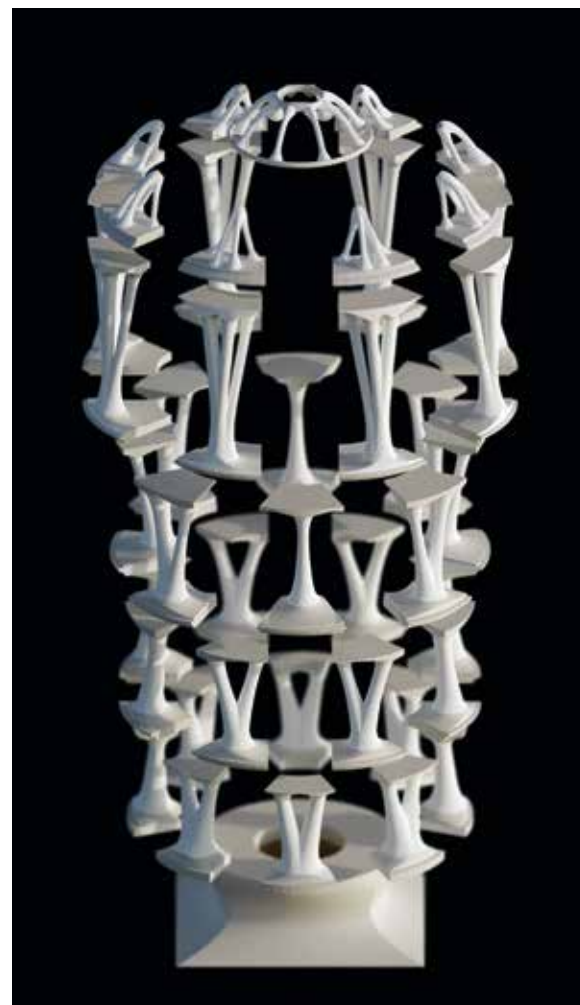
Die sogenannten «Sprengmodelle» zeigen den Aufbau des Turmes aus vielen verschiedenen Einzelteilen.
